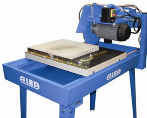
Предназначен для резки камня и других материалов. Возможна резка под углом до 45°. Может работать с дисками диаметром 300 или 350 мм. Водяное охлаждение диска. Станок отлично подходит для выполнения основных работ на строительной площадке. Глубина реза до 100 мм. позволяет резать кирпич, бетонные блоки, бордюры, натуральный и искусственный камень.
