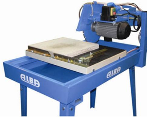
Предназначен для резки камня и других материалов. Возможна резка под углом до 45°. Может работать с дисками диаметром 300 или 350 мм. Водяное охлаждение диска. Станок отлично подходит для выполнения основных работ на строительной площадке. Глубина реза до 100 мм. позволяет резать кирпич, бетонные блоки, бордюры, натуральный и искусственный камень.
